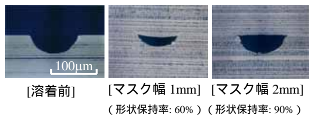
Fig.14 マイクロチャネルの断面写真(位置 )
